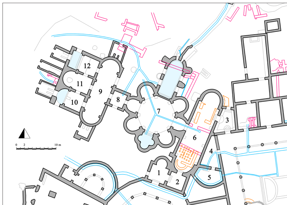
Fig. 1. Le Terme Nord-occidentali della Villa del Casale. Particolare della planimetria: in azzurro condutture e canali; in arancione le strutture precedenti il IV secolo; in fucsia le strutture di età arabo-normanna e medievali (elaborazione di C. Lamanna).
