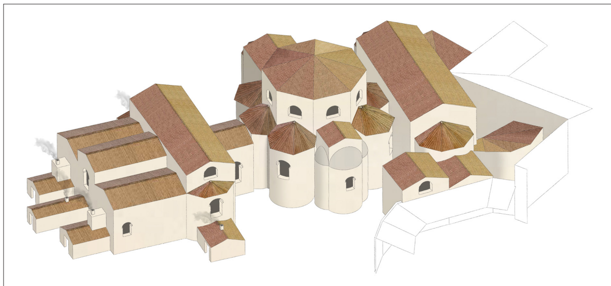
Fig. 9. Ipotesi ricostruttiva delle coperture delle Terme Occidentali, vista da sud-ovest (elaborazione di C. Lamanna).
